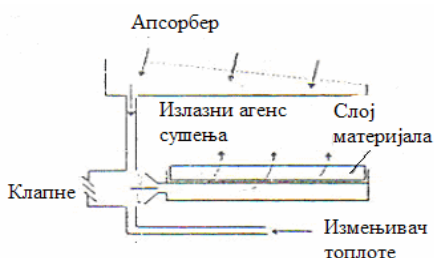
Слика.6. Соларна сушара са допунским извором енергије и сушењем материјала у слоју
